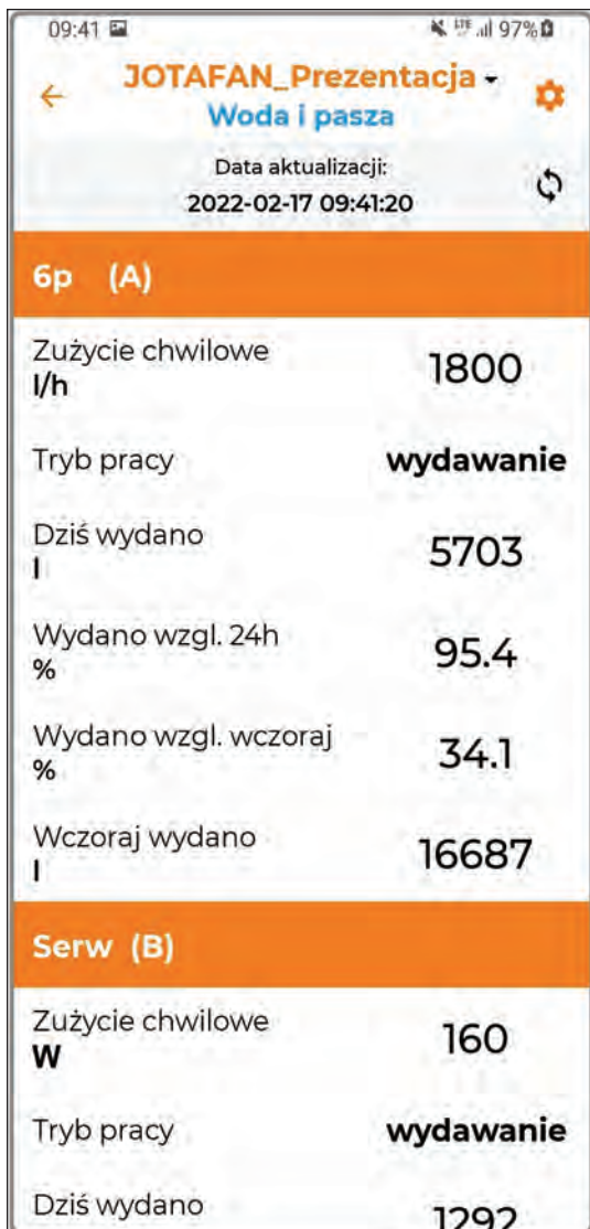
Rys. 5. Ekran „Woda i pasza” w aplikacji FERMA-MOBILE. Na ekranie smartfonu lub tabletu pokazywane są podstawowe dane statystyczne oraz zgłaszane alarmy (w postaci powiadomień PUSH)
