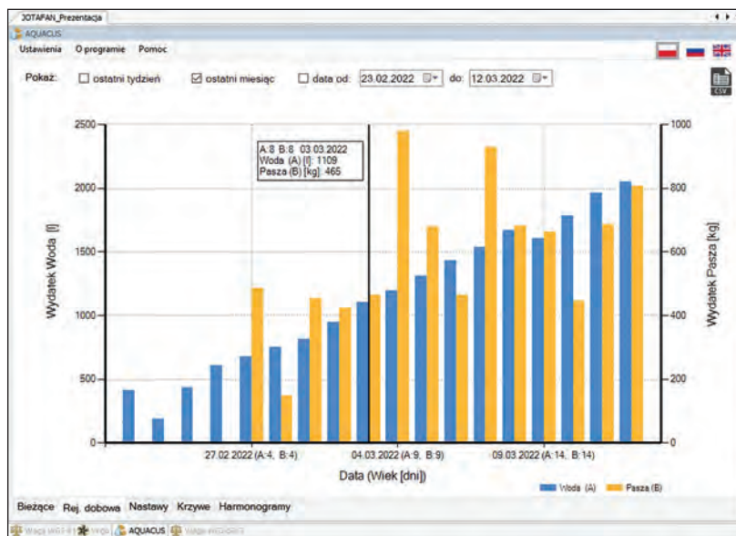
Rys. 3. Okno oprogramowania FERMA - AQUACUS, zakładka „Rejestracja dobowa”. Dobowe spożycie wody w obydwu torach jest zilustrowane na wykresie słupkowym. Można wybrać przedział czasowy do pokazania, a kursor pozwala na dokładny odczyt wartości. Dane można wyeksportować do pliku CSV (np. dla arkusza MS Excel)
